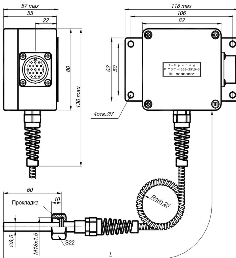
Рисунок 1 – Габаритные размеры РТЗС-4555.
