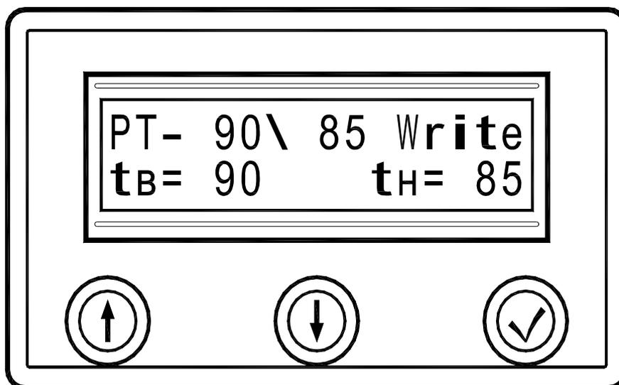
Рисунок 2 – Эскиз лицевой панели ПРТ1С в режиме установки.
